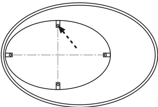
Per motivi di produzione, con i modelli in pelle RONDO WALL e RONDO WALL Feltro il coperchio sono prodotti con un po', alla fine, che è più vicino al muro. Per compensare questo i maniche distanza devono essere inseriti tra le ciglia di montaggio e il muro.
